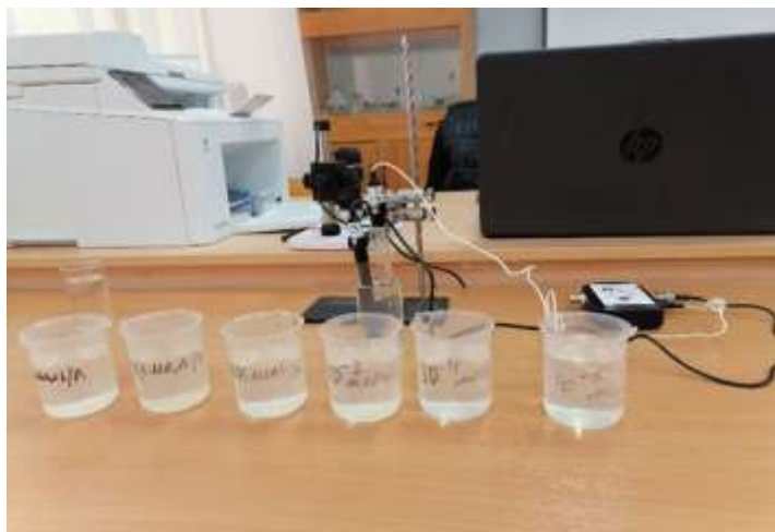
Рис.7. Калибровка датчиков и измерение содержания хлорид- и нитрат-ионов
