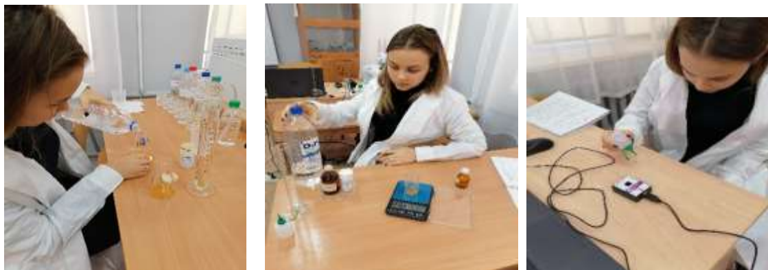
Рис.8.Подготовка градуировочных растворов и измерение оптической плотности
