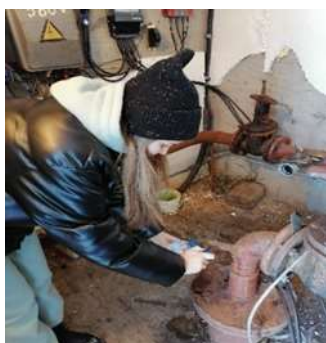
Рис.4. Отбор проб воды с водоочистой станции р.п. Тургенево
