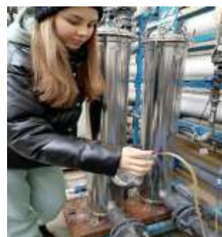
Рис.4. Отбор проб воды с водоочистой станции р.п. Тургенево
