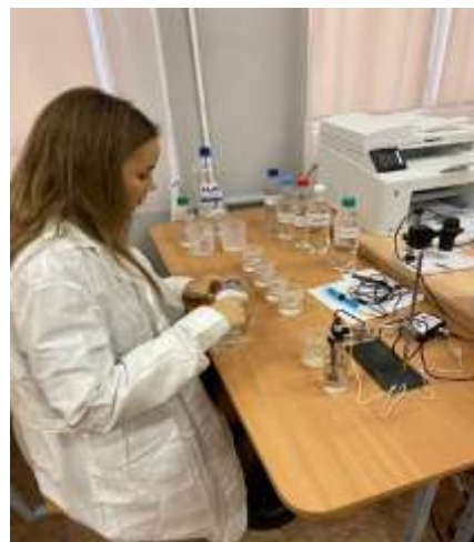
Рис.7. Калибровка датчиков и измерение содержания хлорид- и нитрат-ионов
